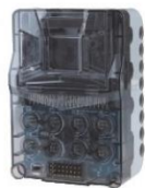
11 1269-W85-A1 名稱 *C-micro:bit 主控盒 材質 PC/ABS
